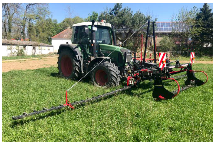
Mechaninė piktžolių kontrolė su šoninių pjovimo aparatų įtempimu
