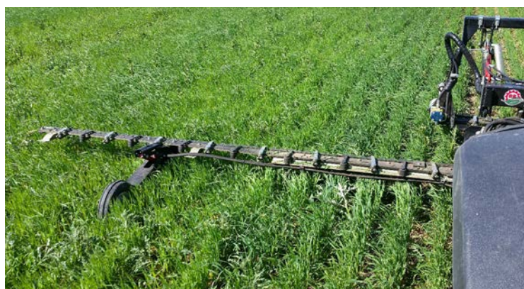
Mechaninė piktžolių kontrolė su hidrauliškai reguliuojamu ratuku
